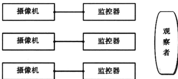
图 1 一个简单的传统 CCTV 系统，带有直接连接到模拟摄像机上的监控器，不能理解视频。
