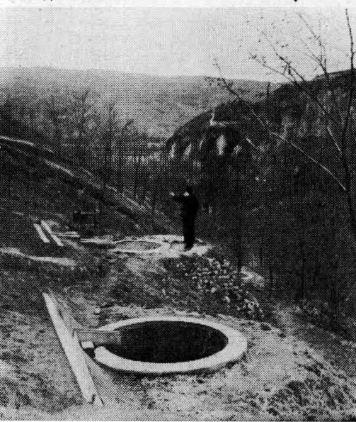
甘肅天水水土保持站梁家坪試驗場設置的逕流小區。觀測研究不同坡地，不同被覆，不同耕作方法，對於水土流失的影響，用科學驗證尋求水土保持方法。
