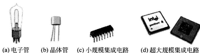
图 1-2 电子管、晶体管与集成电路
