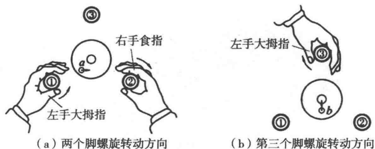
图 1-3 自动安平水准仪整平方法
