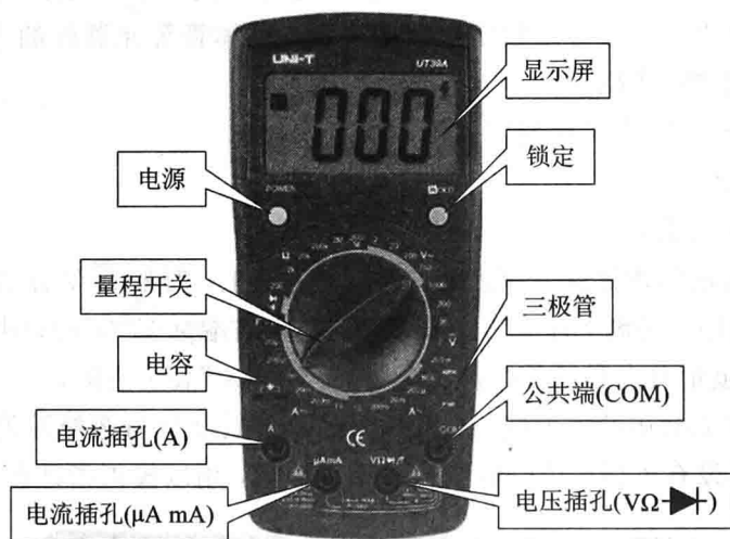
图 1.2 UT39A 数字万用表的外形
