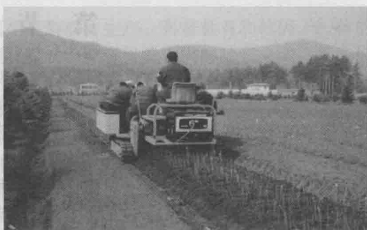
图1-2 苗木移植机进行苗木移植作业, 一定程度上减少了劳动力
