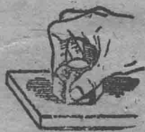
圖 10 手指擰緊螺帽時產生一個力偶
