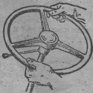
圖 9 司機的手對轉向盤的作用產生一個力偶
