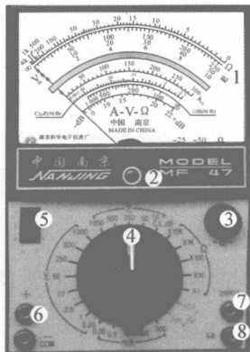
图 1-1-2 MF-47 型万用表实物图
