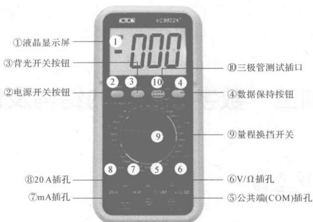
图 1-2-1 VC-9802A 型数字万用表面板结构
