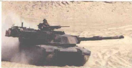
种新式贫铀装甲的密度是普通均质钢的2.6倍，经特殊生产工艺处理后，其抗拉、抗冲击强度可提高到原来的5倍，因此坦克整体防护力大为提高，能同时防御动能弹和化学能弹的攻击。
