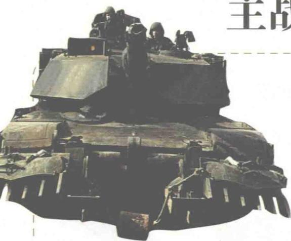
在 M1A1 主战坦克炮塔两侧各有 8 个烟幕弹 - 榴弹发射器
