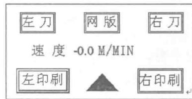
然后根据“左刀对应右印刷，右刀对应左印刷”的原理来完成印刷工作。
