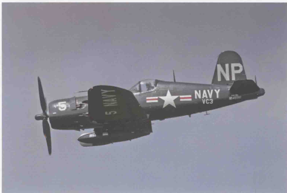
■ 一架在纽约州杰纳西奥航展中表演的F4U-5NL，这架“海盗”曾在洪都拉斯空军服役。机腹挂载空中截击雷达和154加仑副油箱。
