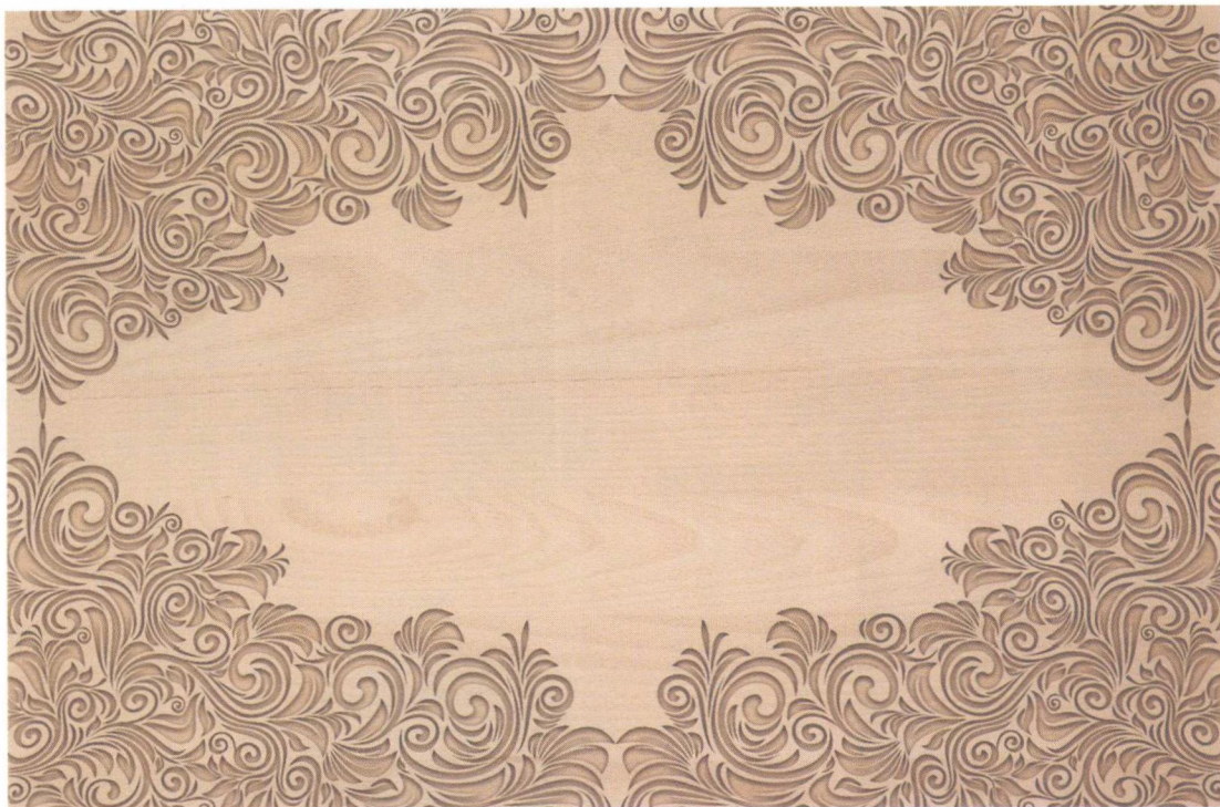
图 1-17 胶合板上的木刻显示内层单板颜色
