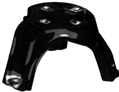
图 1.2 详细设计方案的应力模拟
