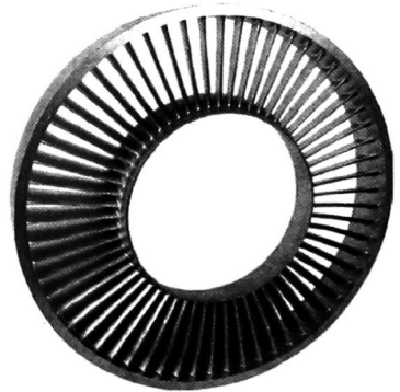
图 1.8 钛合金材质的熔模铸造件 (图片来源: Tital 股份有限公司)
