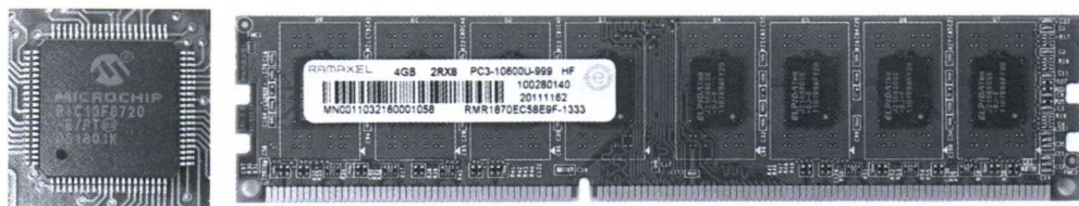
图1-5 只读存储器ROM与随机存储器RAM
