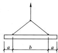
23. 图中所示吊车梁，吊车从 B 点向跨中 O 点平移，则下列关于吊车梁受力的描述正确的是( )。
