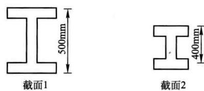
38. 压杆临界力的计算公式为  $P_{ij} = \frac{\pi^2 EI}{l_0^2}$ ，图 A 中杆件的临界力为  $P_A$ ，图 B 为在图 A 的杆件中部增加一链杆，临界力为  $P_B$ 。则有( )。
