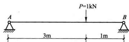
9. 梁的支承与受力如图， $A$  为铰支座， $C$  为固定支座，则支座  $A$  处的反力  $R_A$  为( )kN。
