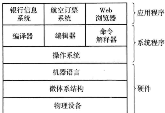
图 1.1 计算机系统由硬件、系统程序和应用程序组成
