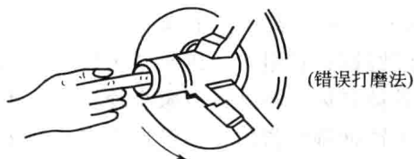
图 1-2 用手指绕砂布打磨内 螺纹纹断手指示意图
