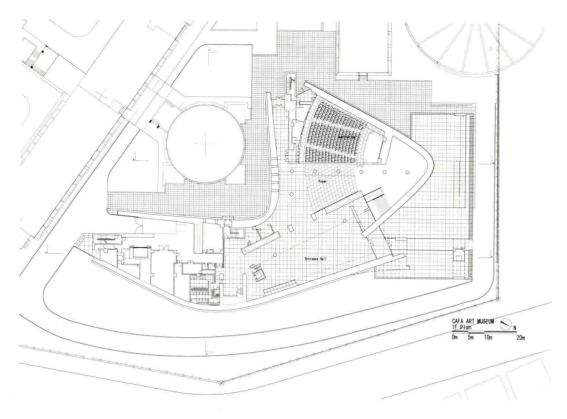
三个自由曲面的端部在平面布局上分别为主入口,连接报告 厅的入口以及货物出入口,在垂直空间上则提供了可以引入 自然光线的采光天窗。设备管道井,电梯和楼梯间等纵向交 通空间则隐藏在几个矩形建筑体量内部,其作为独立的形体 穿插于曲面墙体的内外。针对内部空间则利用水平的楼板进 行垂直方向的分隔,或将夹层直接凌驾于空中来构成立体的 展示空间,错落有致的楼层之间采用坡道平滑连接。
