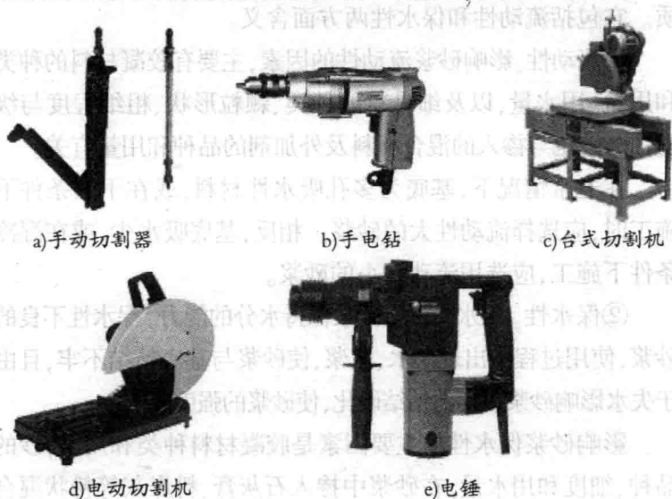
图1-7 贴面装饰施工用的机具
