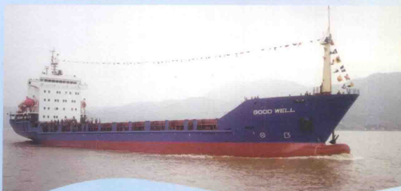
马尾造船厂开发研制的第二型高科技出口船— 595TEV/7300 t多用途集装箱货船。(入德国GL船级, 批量出口香港地区)
