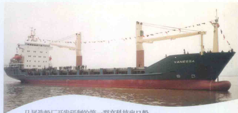
马尾造船厂开发研制的第一型高科技出口船 — 598TEV/7300 t多用途集装箱货船。(入德国GL船级, 批量出口德国)
