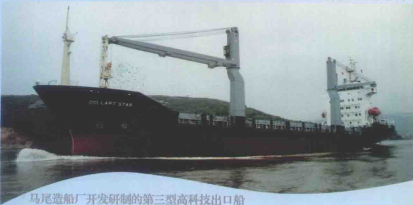
马尾造船厂开发研制的第二型高科技出口船— 595TEV/7300 t多用途集装箱货船。(入德国GL船级, 批量出口香港地区)
