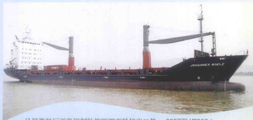
马尾造船厂开发研制的第四型高科技出口船— 660TEV/7800 t 多用途集装箱货船。(入德国GL船级, 悬挂德国旗, 批量出口德国)
