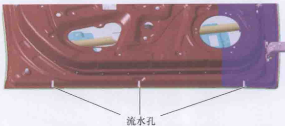
图 4-18 车门流水孔的 DMU 示意图
