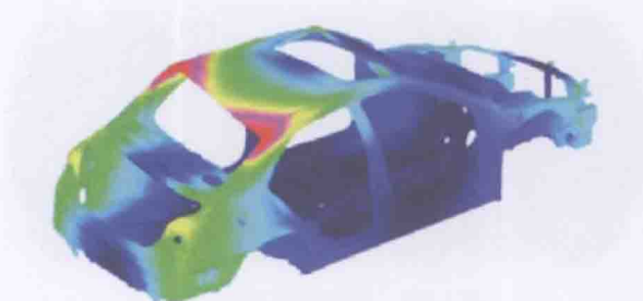
图 2-40 车身的第-阶扭转模态图
