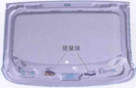
图 3-80 在行李箱后盖板上加两块质量各为 1.5kg 的铁块
