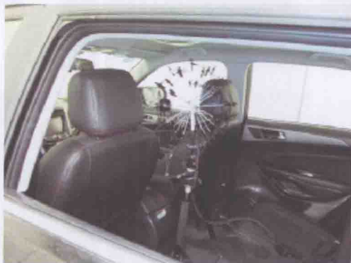
图 3-42 用球形阵列测量某款车内噪声的照片
