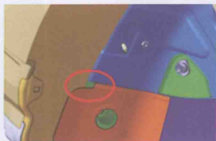
图 4-19 轮毂包上三块板交汇处的 DMU 示意图
