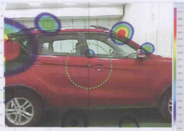
图 3-39 某个车身在 192Hz 的声源分布
