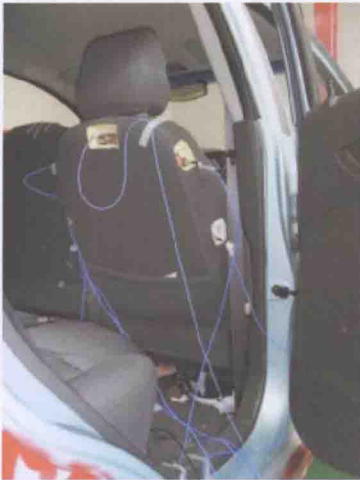
a) 剥开骨架边的部分材料，布置传感器
