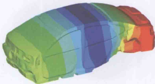
图 3-9 某车身的第 一阶声腔模态图
