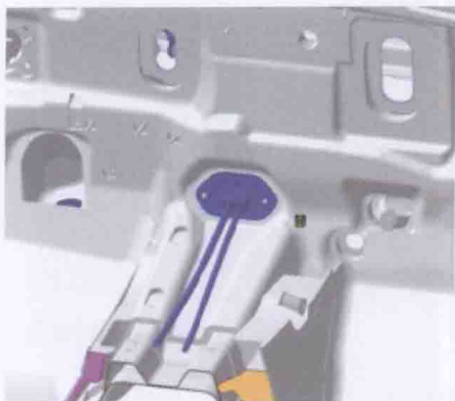
图 4-17 换挡拉索穿过前壁板的 DMU 示意图
