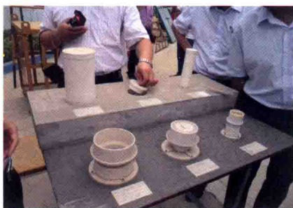
图 1.1.1-1 PVC 管穿楼板预埋 效果图（一）
