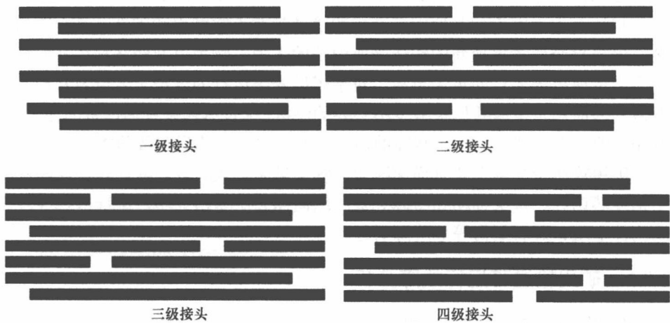
图 1-2 钢绳芯搭接示意图
