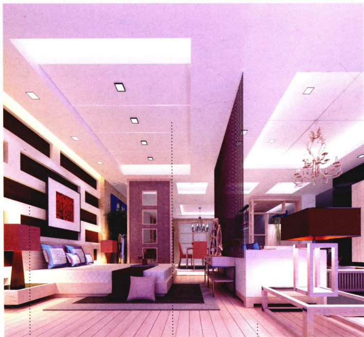
细木工板造型 + 咖色乳胶漆 石膏板造型 实木复合地板
