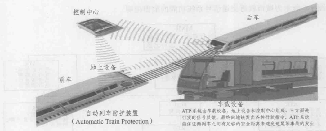
图 1-5 ATC 设备控制列车运行示意图
