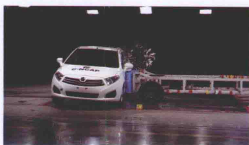
图 13 侧面碰撞测试
