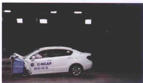
图 12 正面 40% 碰撞测试
