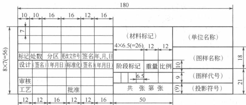
图 1-3 标题栏的格式及尺寸
