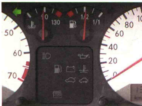
检查各仪表、指示灯工作是否正常，注意看燃油表的油量
