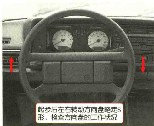
检查各仪表、指示灯工作是否正常，注意看燃油表的油量
