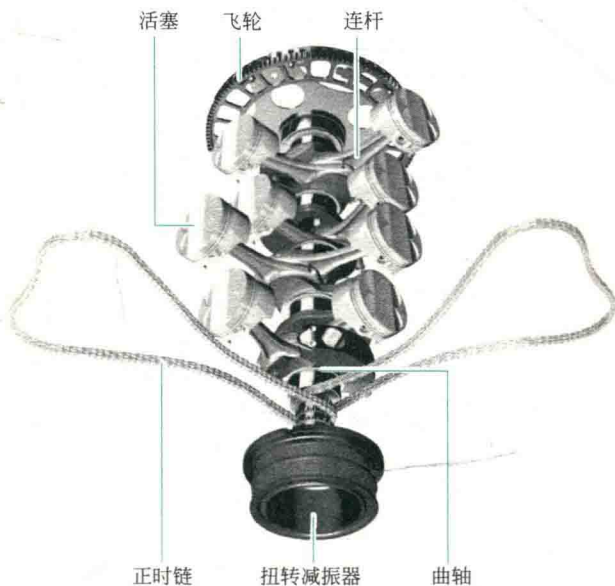
图 1-5 曲柄连杆机构
