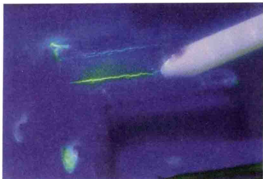
紫外线下显示的小裂缝
