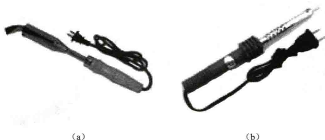
图 1-8 电烙铁 (a) 外热式; (b) 内热式
