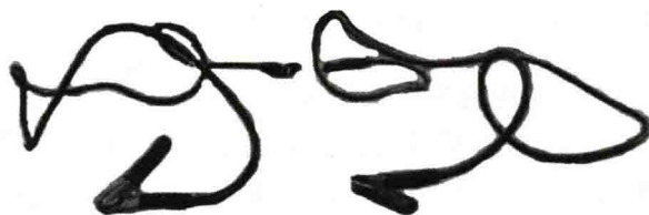
图 1-14 蓄电池跨接电缆线（正、负线）
