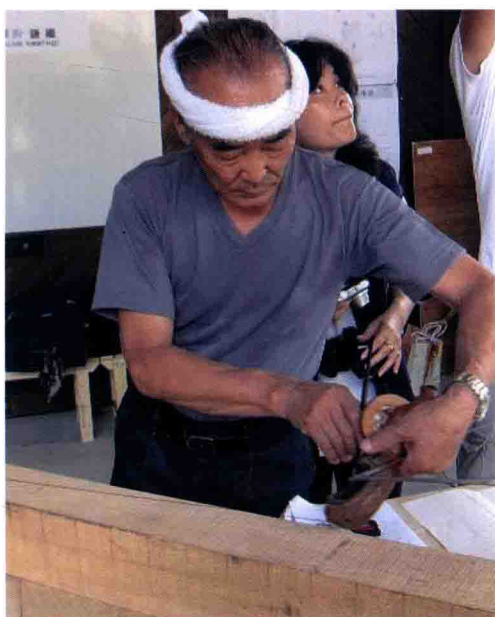
◎定針固定，左手持墨斗，以竹筆擠壓墨田棉線，把染墨的線拉出來。
