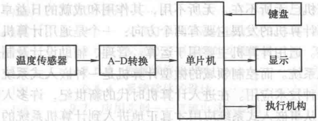
图 1-1 温度测控系统框图
