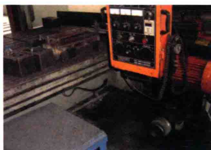
图 1-9 切屑满身的机床
