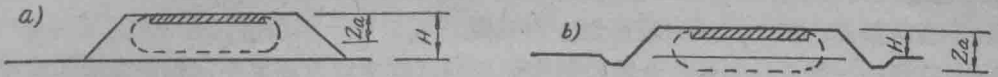
图4-2-2 路基高度与应力作用区深度的关系示意图 a) H > Z_{a3} b) H < Z_{a3}
