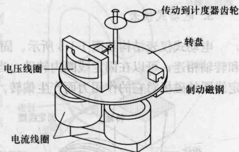
图 1-1-5 感应式仪表结构
