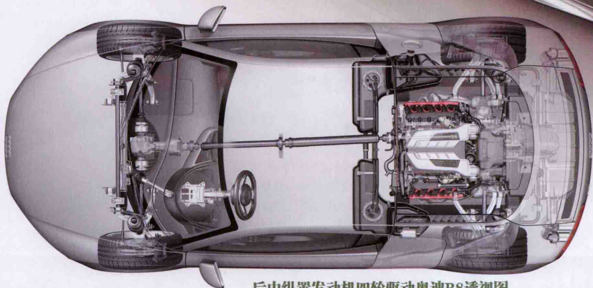
后中纵置发动机四轮驱动奥迪R8透视图
