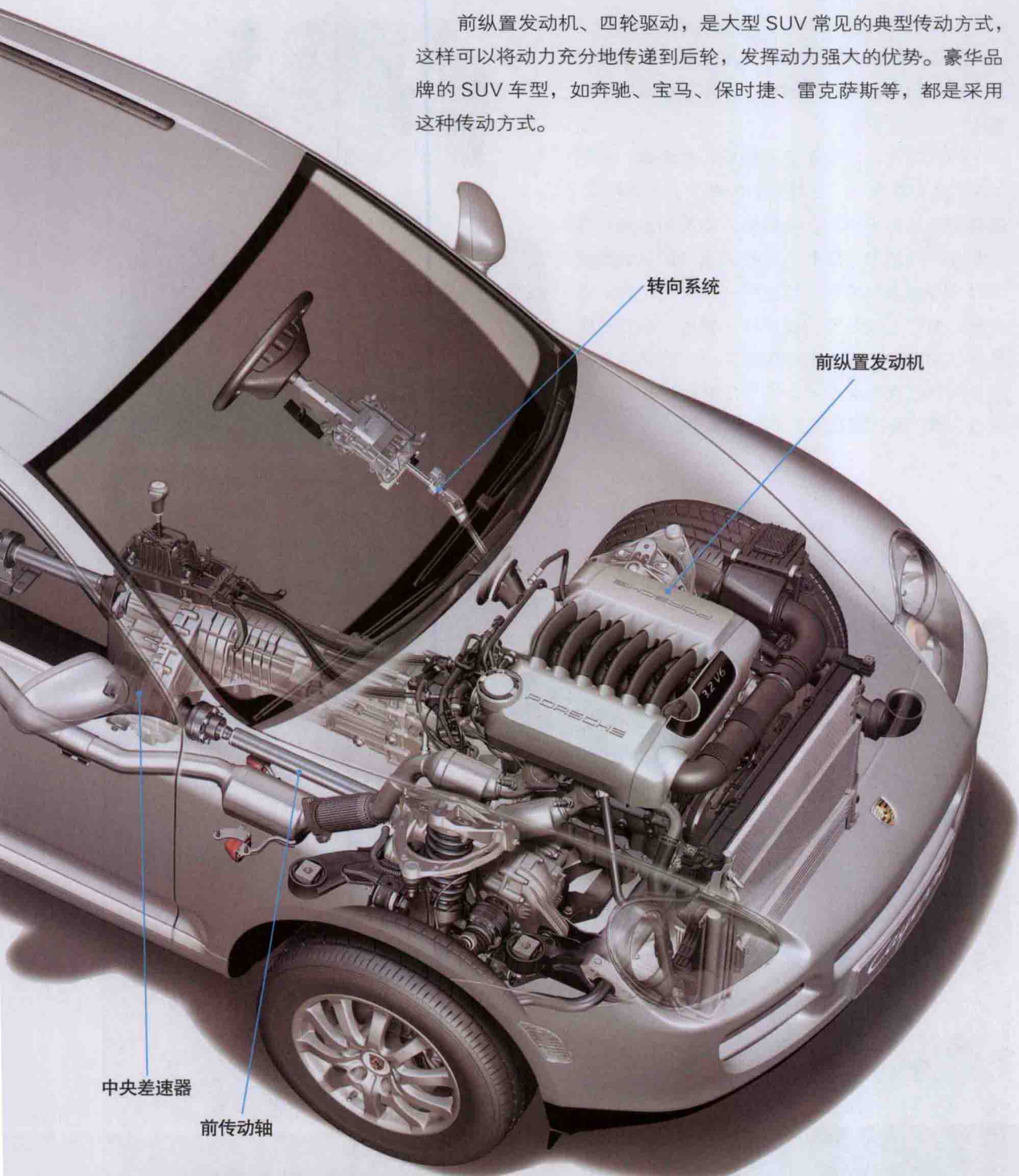
保时捷卡宴动力系统构造图
