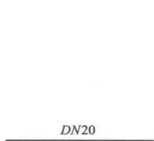
图 1-5 单管管径表示法
