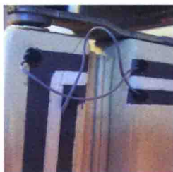
图L: 越过门和侧板间隔的磁铁、电线。
