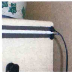
图K：电源通过磁铁与电路相连。
