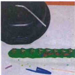
图R：要放进去的第一行磁铁（已经添加了环氧树脂，磁铁在左下方）。
