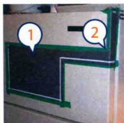
图H：1. 导电涂料尽量覆盖得厚一些。2. 由外向内撕掉覆盖的胶布。
