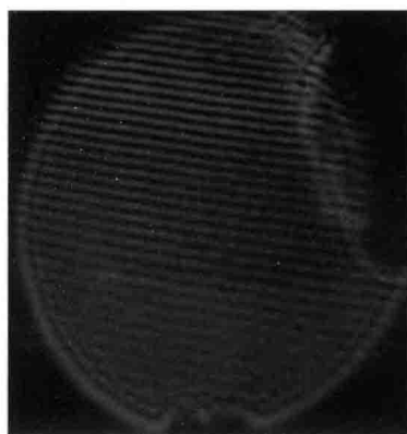
图4 菲涅耳双面镜实验
