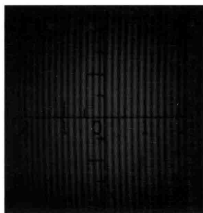
图3 光纤的双缝干涉实验
