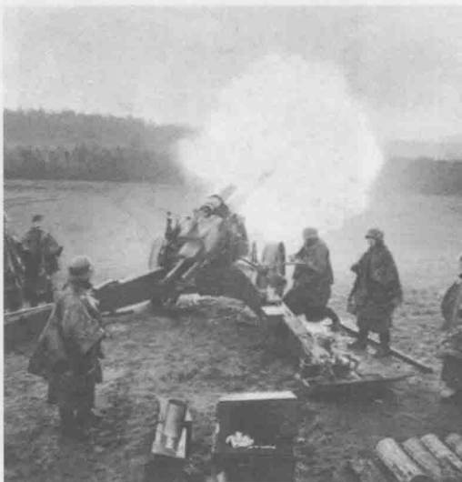
上图：一门德军15厘米口径的野战炮正朝法军阵地开炮。开火前，每发炮弹都从蜡盒中拖出（底部右方）。蜡盒是用来在运输中保护炮弹的。
