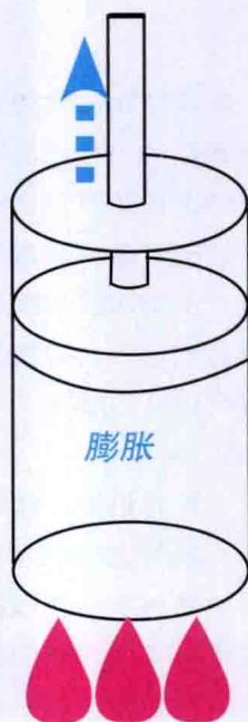
外燃机工作原理示意图
