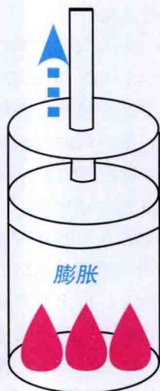
内燃机工作原理示意图
