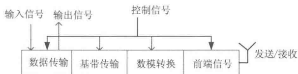
图 1-3 SDR 收发器工作原理
