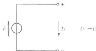
图 1-8 直流电压与电动势的关系
