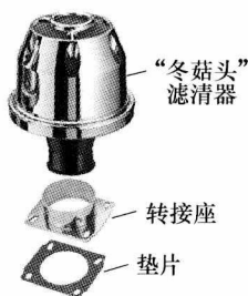
图 1-5 通过转接座安装
