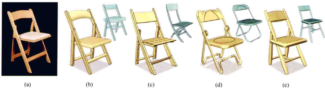
彩图 11 基于单幅图像和不同候选模型的椅子建模结果 (第 23 章第 23.3 节). (a) 真实椅子的照片; (b) ~ (e) 根据 (a) 和不同候选椅子模型 (每幅子图的右上角小图) 的建模结果 (每幅子图的左下角大图)
