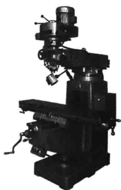
普通铣床上没有数控系统装置
