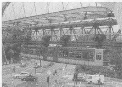
图 1-5 悬吊式单轨交通
