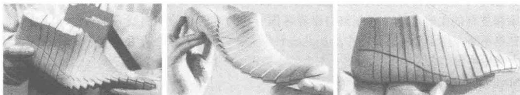
图1-5 耐克公司最近推出的可以移动弯曲和扭转的鞋楦
