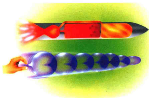
▲ 火箭的推进原理就如同松开灌满气的气球一样，往后喷出气流产生反作用力，把火箭往前推进
